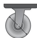
**Diâmetro (pol.):** Considere as irregularidades do piso. Um maior diâmetro facilita a transposição de qualquer obstáculo. E, claro, este diâmetro deverá ser proporcional à altura do equipamento e à carga em movimento.
